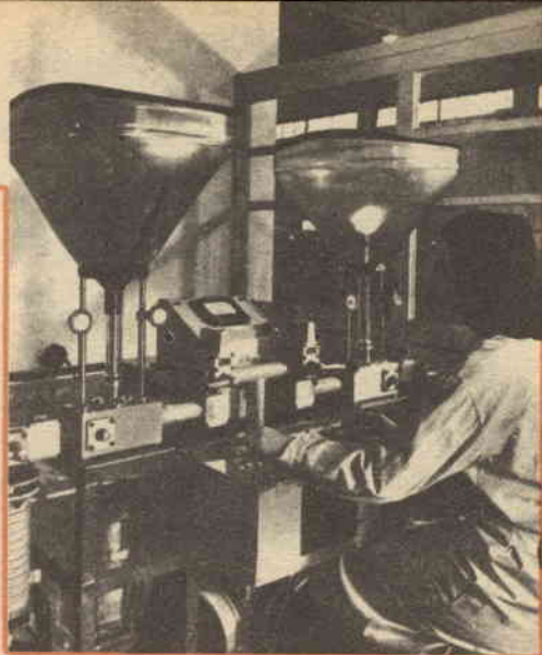
Deposizioni dei fosfori e collaudo preliminare dello schermo di moderni cinescopi.
