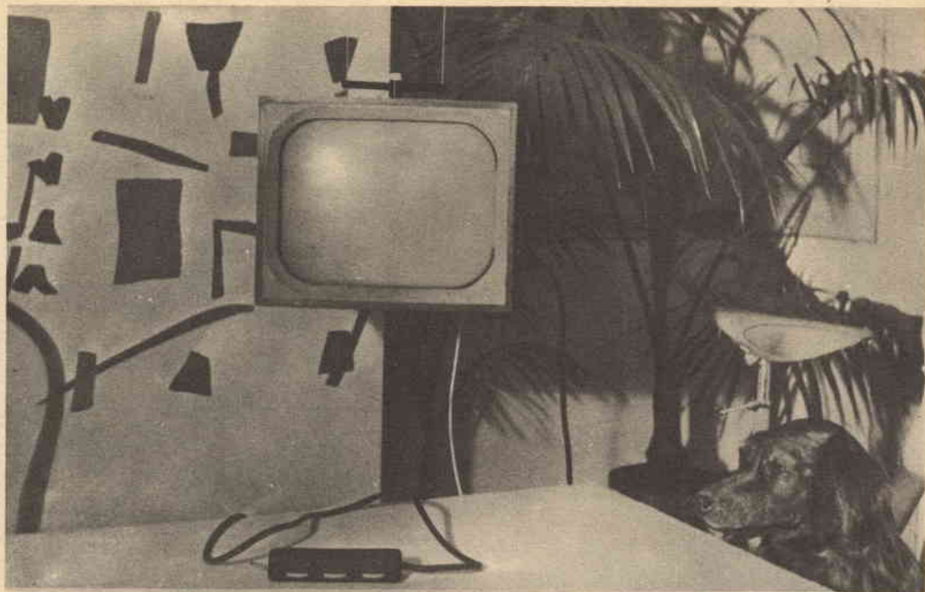
L'apparecchio televisivo sospeso al muro. Si noti il contrappeso che sposta orizzontalmente il televisore.
